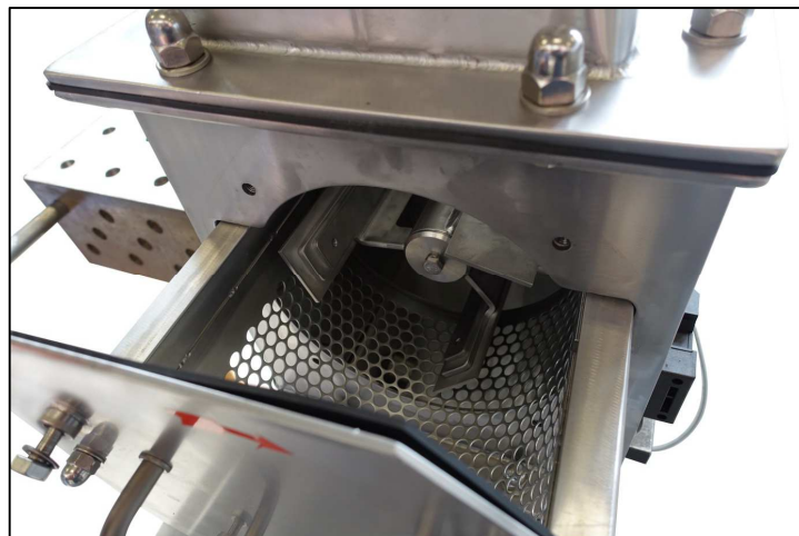
Abb 2: Blick ins Innere: Das Passiersieb JEL PS200 mit Siebkorb, Rotor und den Passierleisten (Quelle: j. Engelsmann AG)
