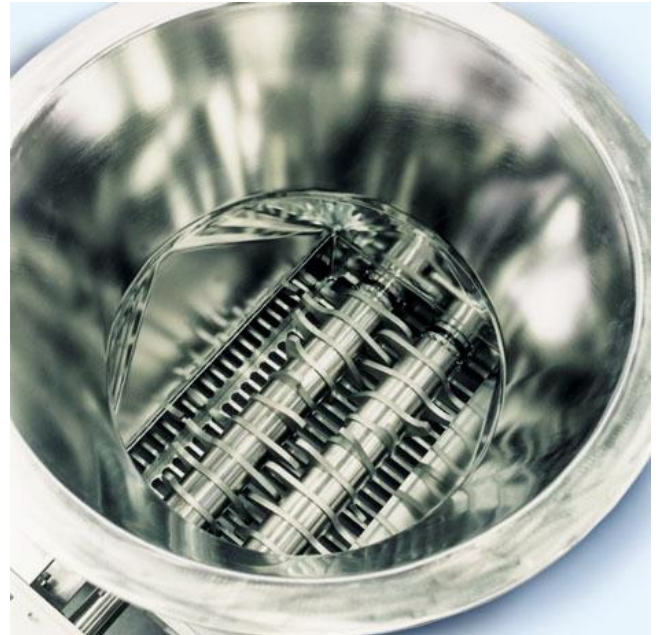
Doppelwellenbrecher mit Brechrost und Brecherwellen Double-Shaft Crusher with grate and breaking shafts
