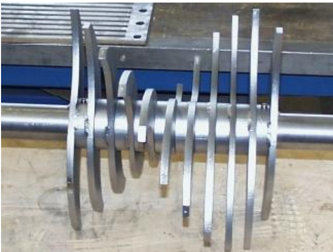
Brecherwelle mit sichelförmigen ineinander greifenden Brechermesser. Crushing shaft with crescent shaped interlocking crusher knives.
