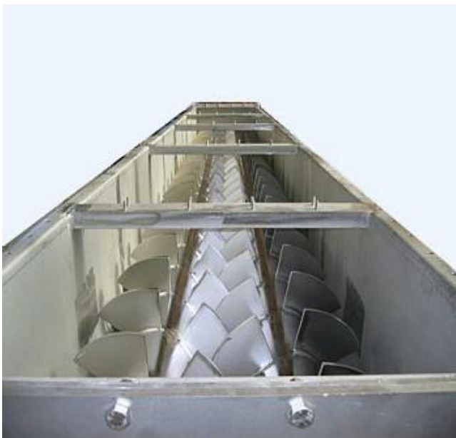
Wirbelschneckenmischer Typ WSM 2 x 500 Palettenmischwerk Vortex Screw Mixer type WSM 2 x 500 - pallet mixing tool
