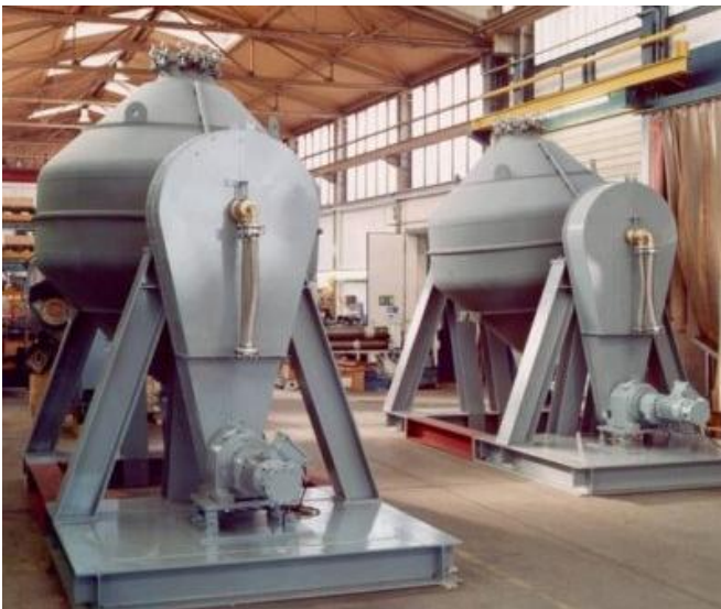
Doppelkonustrockner Typ DKT 6800 für 16 bar Dampfheizung Double Cone Dryer type DKT 6800 for steam heating 16 bar
