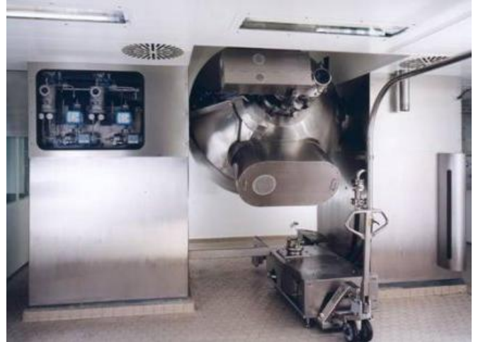
Doppelkonustrockner Typ DKT 2500 in Werkstoff C22 für Pharmaeinsatz Double Cone Dryer type DKT 2500 of material C22 for pharmaceutical application
