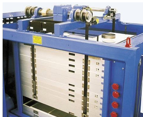
Regula Standard mit Anhebevorrichtung für einfachen Siebwechsel
