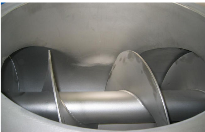
Vollblattgewinde Full-segment thread
