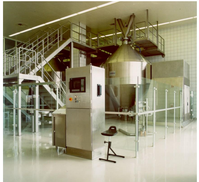
Doppelkonusmischer Typ DKM 21000 in Pharmaausführung mit CIP-Abreinigung Double Cone Mixer type DKM 21000 in pharmaceutical execution equipped with CIP cleaning
