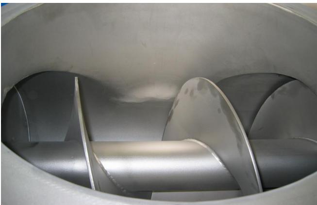
Vollblattgewinde Full-segment thread
