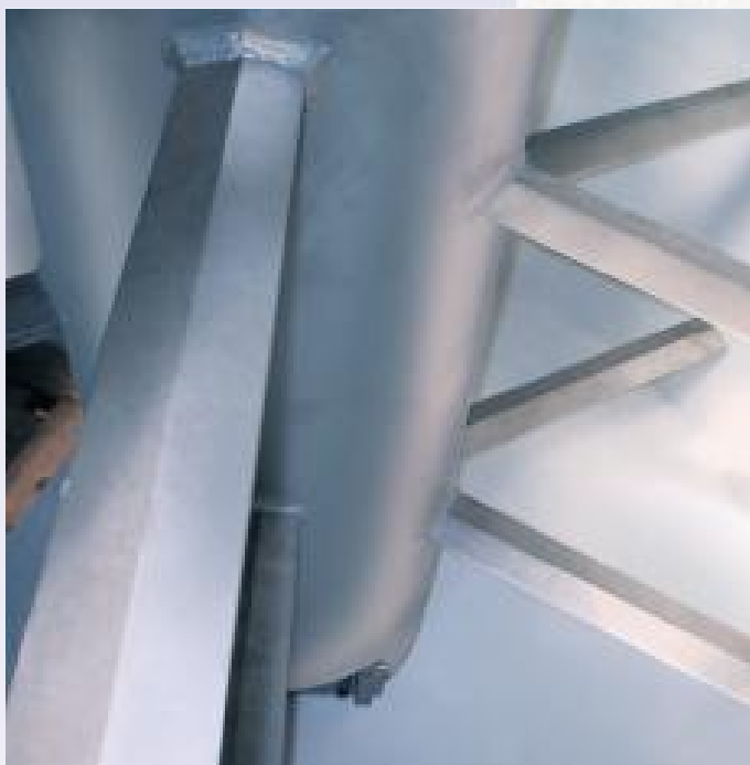
Austragsbehälter Innenansicht mit Rührerwelle und hoch- korrosionsfester Beschichtung Inside view of the discharging container with agitator shaft and highly corrosion-resistant coating
