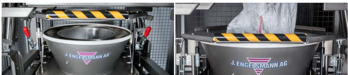
// Staubdichte Big Bag-Anbindung über ein doppeltes Führungsrohr.
