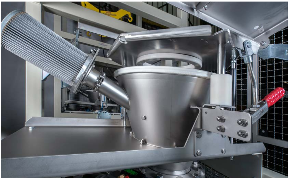
// Einfacher Verdrängungsfilter am Entleertrichter
