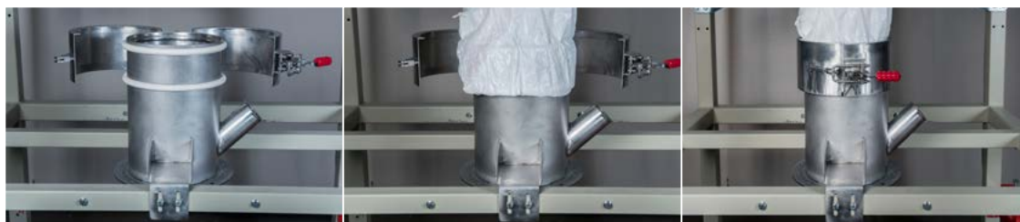
// Staubarme Big Bag-Anbindung über ein einfaches Führungsrohr.
