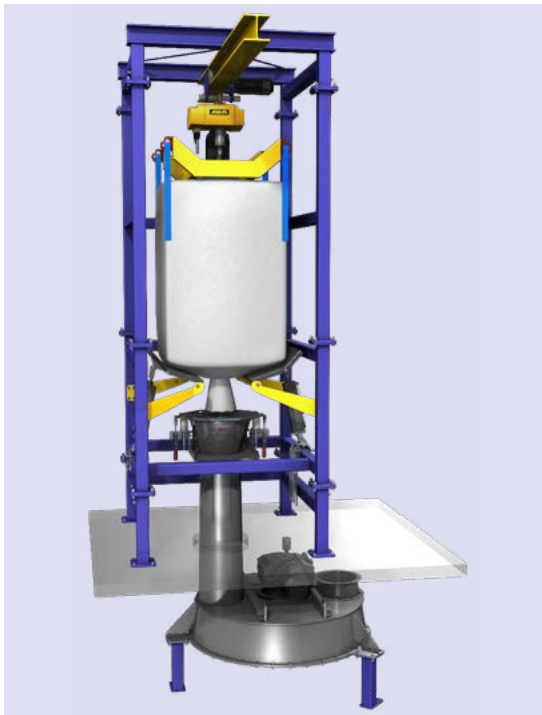
// Gravimetrische Entleerung eines Big Bags in ein darunter angebautes Rührwerk
