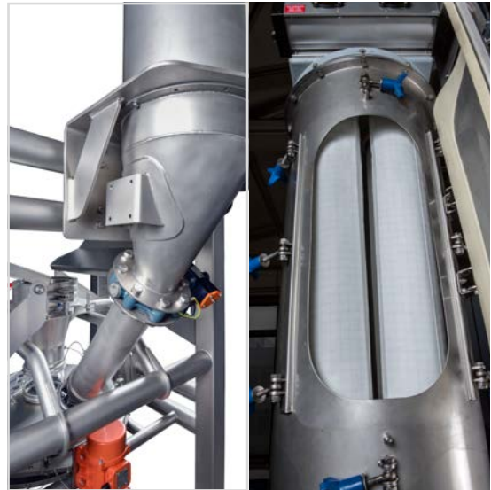
// Hygienic Design - Saugfilter mit Ventilator, (links) und Schlauchfilterelemente eines Saugfilters (rechts)
